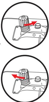
Поверните рукоятку по часовой стрелке, чтобы затянуть пружину.
