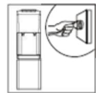
Следите за наполнением водой лотка каплесборника. При наполнении лотка водой, красный индикатор наполнения лотка поднимается вверх. Вовремя опорожняйте лоток каплесборника от воды.
